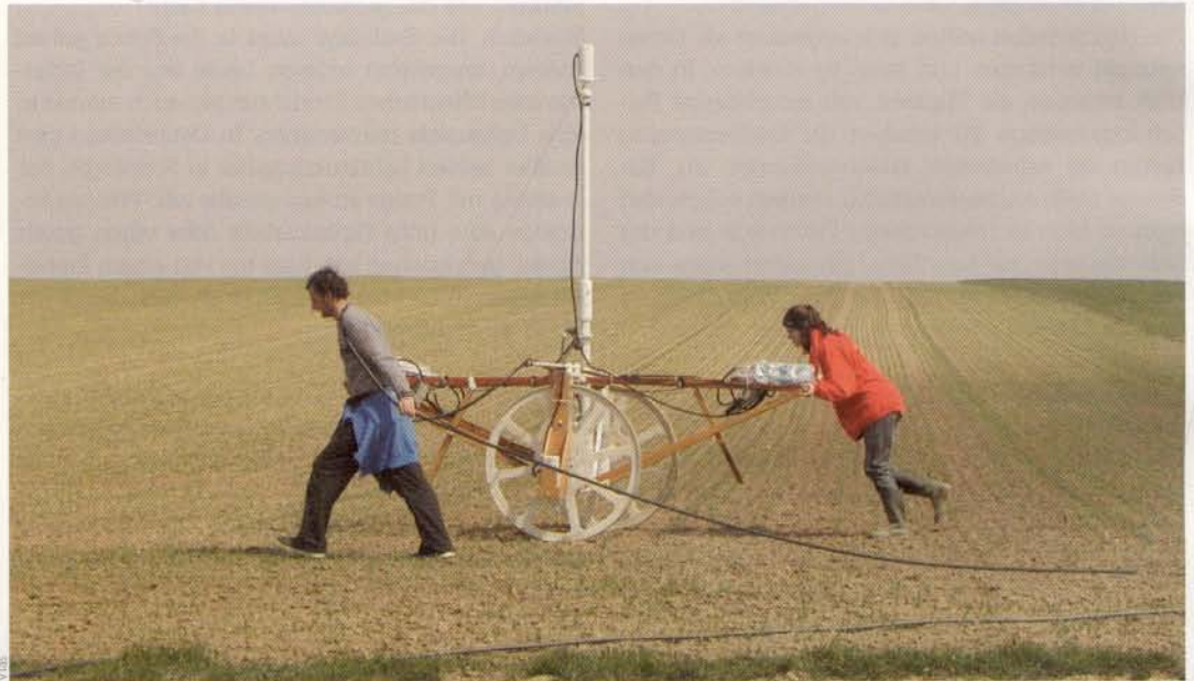
Röntgenblick in die Erde, Lichtblick für die Archäologie – nur dank außeruniversitärer Kooperationen kann dieses Magnetometersystem zum Einsatz kommen
